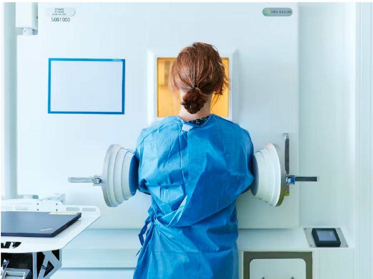
In stark bleigeschützten Behältern, sogenannten Hot Cells...
